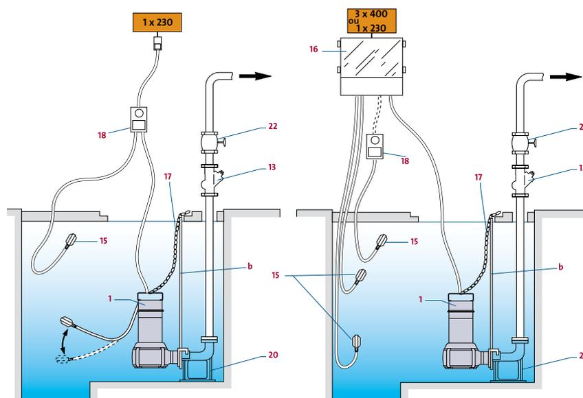
Code repère de l'accessoire, indiquant sa position sur le schéma
