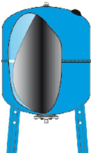
Lorsque la pression du système atteint son niveau maximal prédéterminé, **la pompe s'arrête**. À ce moment-là, le réservoir contient la quantité maximale d'eau. La vessie se dilate pour occuper presque tout le volume interne du réservoir. Si le système en a besoin, l'eau est **libérée sans solliciter la pompe**, en utilisant uniquement la pression présente dans le coussin d'air.
