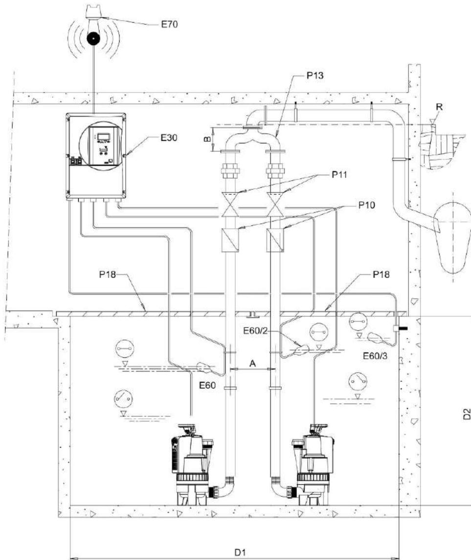
III. 6: Exemple d'installation station de pompage double AmaDrainer 354
